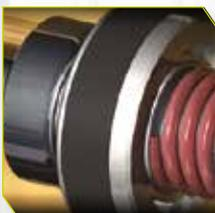
Banda de pistón vulcanizada que asegura un contacto uniforme con el tubo de cilindro, garantizando una total hermeticidad entre las cámaras de aceite y prolongando la vida útil del pistón. Mayor relación Vástago/Cilindro que asegura una eficaz refrigeración del amortiguador, aumentando su vida útil.
