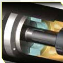
Tope hidráulico que absorbe a altas velocidades y desplazamientos el impacto del sistema de tracción sobre la guía, protegiendo el amortiguador y la suspensión del vehículo.
