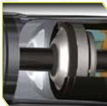
Sistema de cierre CRL (Cierre Rolado Lateral) que permite una mayor resistencia en el movimiento de tracción y asegura la estanqueidad del aceite en el amortiguador.
